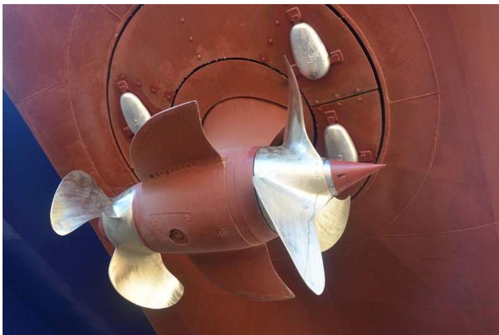
Rys. 4. Rufowy pędnik azymutalny. Nowoczesny rodzaj napędu umożliwia swobodne manewrowanie jednostki we wszystkich kierunkach, szybką zmianę kursu oraz płynną zmianę prędkości.
