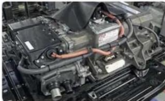
Moduł ogniw paliwowych gotowy do montażu
