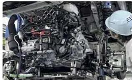
Montaż sterownika mocy wraz z silnikiem elektrycznym na wysokości przedniej osi Mirai
